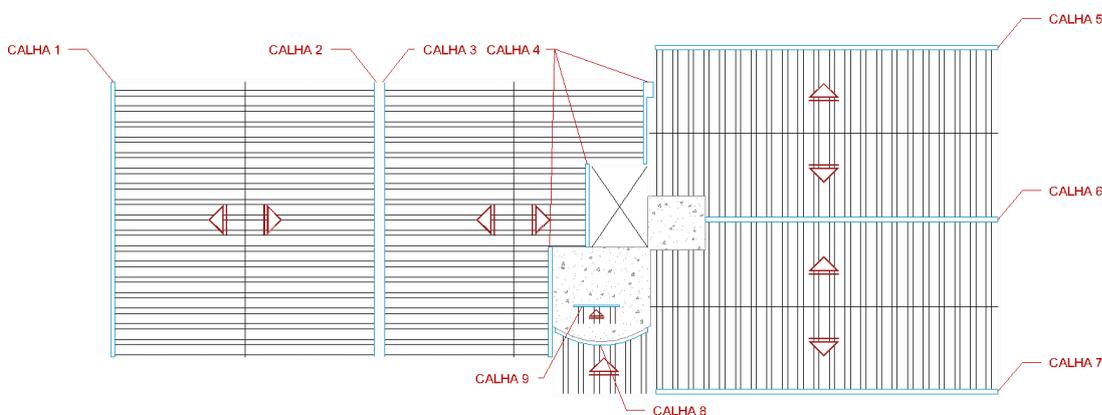
Figura 1 - Planta da cobertura com as calhas indicadas.
